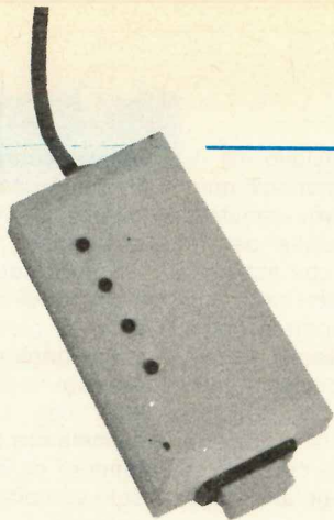
Fig. 1 Il preamplificatore-miscelatore descritto in questo articolo andrà applicato direttamente sul palo di sostegno delle antenne sfruttando come ingressi per tali antenne i quattro cavi coassiali di sinistra. I tre cavi coassiali di destra potremo invece utilizzarli per collegarvi l'antenna VHF oppure quella UHF per il 2° programma RAI. Se quest'ultima antenna dispone di preamplificatore dovremo utilizzare il solo cavo coassiale posto al centro lasciando inutilizzato il rimanente.
